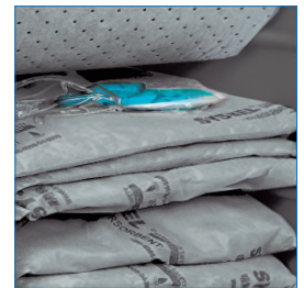
Interior carro contiene implementos absorbentes para derrame de líquidos y aceites.
